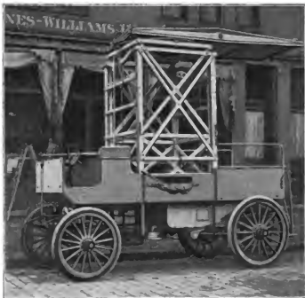
Fig. 225. Automobil-Montagewagen von O. G. Roberts & Co., Columbus O. (Plattform gesenkt.)
